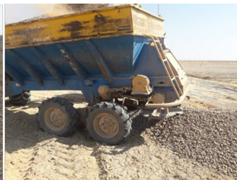
شکل ۱. پاشش سنگریزه با استفاده از کودپاش اصلاح شده
